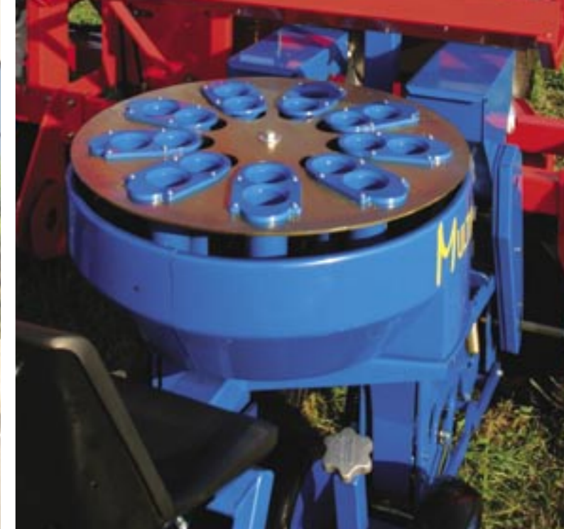
DISTRIButore BIFILA BREVETTATO / PATENTED DOUBLE ROW CAROUSEL BARILLET DOUBLE RANG BREVETE / PATENTIERTE DOPPELREIHENVERTEILUNGSVORRICHTUNG DISTRIBUIDOR DE DOS FILAS PATENTADO
